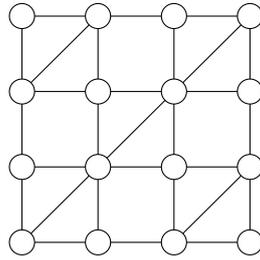
Aber nicht jede Wahl von fünf Diagonalen stabilisiert das Gerüst.
