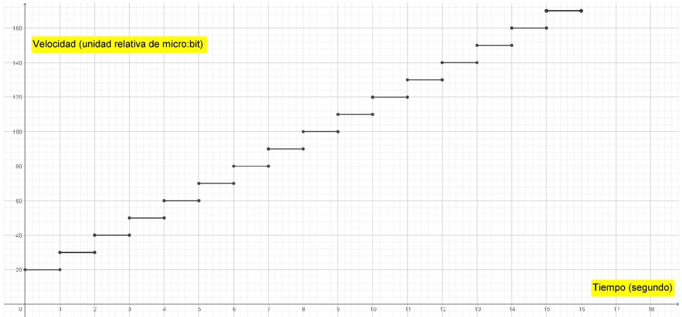
El código de la placa receptora debe, primero, recibir la señal numérica enviada por radio. Y en ese momento aumentar la velocidad en 10 unidades cada segundo. Hasta alcanzar la velocidad 170 y parar en seco tras avanzar un segundo a esa velocidad máxima.
