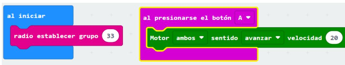
Cuando el robot en movimiento pase delante del robot que contiene a la placa emisora (a una distancia inferior a los 20 cm), recibirá por radio el valor numérico 1. En el momento que la placa receptora reciba esa señal de radio, comenzará la aceleración de su movimiento.
