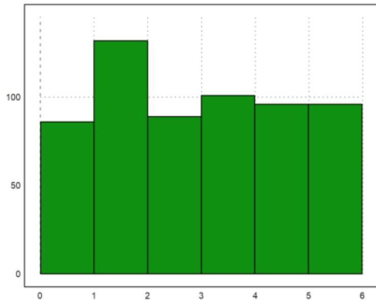
Untuk distribusi, ada parameter `distribution=n`, yang menghitung nilai secara otomatis dan mencetak distribusi relatif dengan n sub-interval.
