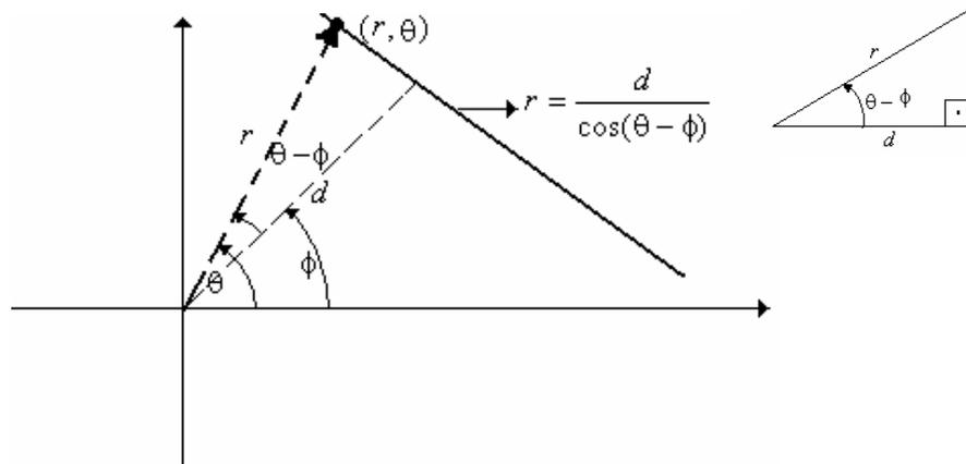
Del triángulo tenemos:  $\cos(\theta - \phi) = \frac{d}{r}$
