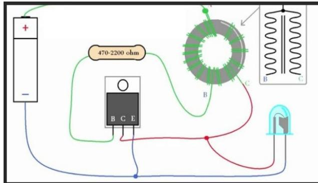
En sencillas palabras mediante el circuito básico, queremos comprobar que se puede encender un led con una pila que antes no tenia el voltaje necesario para lograrlo,amplificando su voltaje mediante una bobina toroidal. ¡Manos a la obra!
