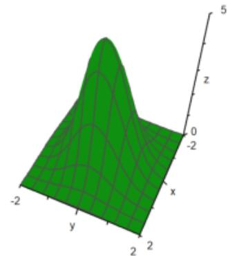
Sebuah plot kutub juga tersedia. Parameter `polar=true` menggambar plot polar. Fungsi tersebut harus tetap merupakan fungsi dari x dan y. Parameter `"fscale"` menskalakan fungsi dengan skala sendiri. Jika tidak, fungsi diskalakan agar sesuai dengan kubus.
