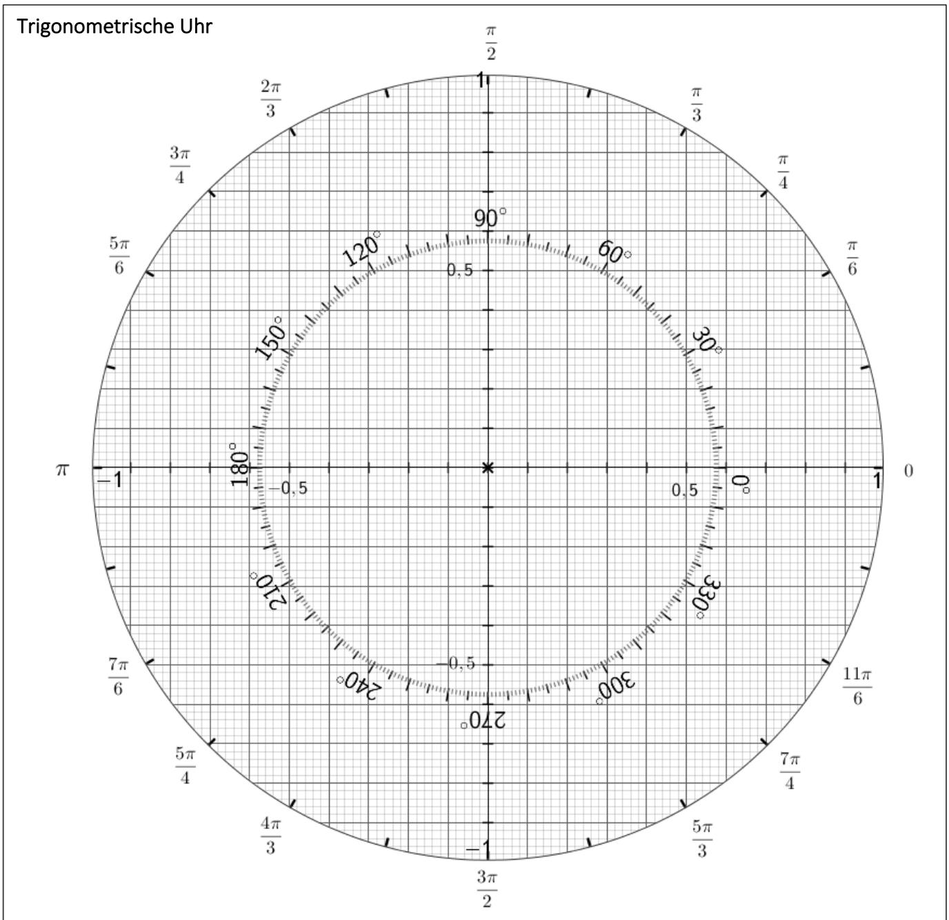
Drucke das Blatt aus (DINA4 oder DINA3). Schneide den Kasten oben, den Zeiger und aus dem Zeiger das Sichtfenster aus (ggf. vorsichtig mit einem Cuttermesser). Laminiere Uhr und Zeiger und zeichne die Mittellinie des Zeigers im Sichtfenster auf der Folie mit einem Perennantschreiber durch. Verbinde Zeiger und Uhr mit einer Nadel, Reißzwecke, Büroklammer oder Musterklemme so, dass der Drehpunkt des Zeigers im Ursprung liegt.
