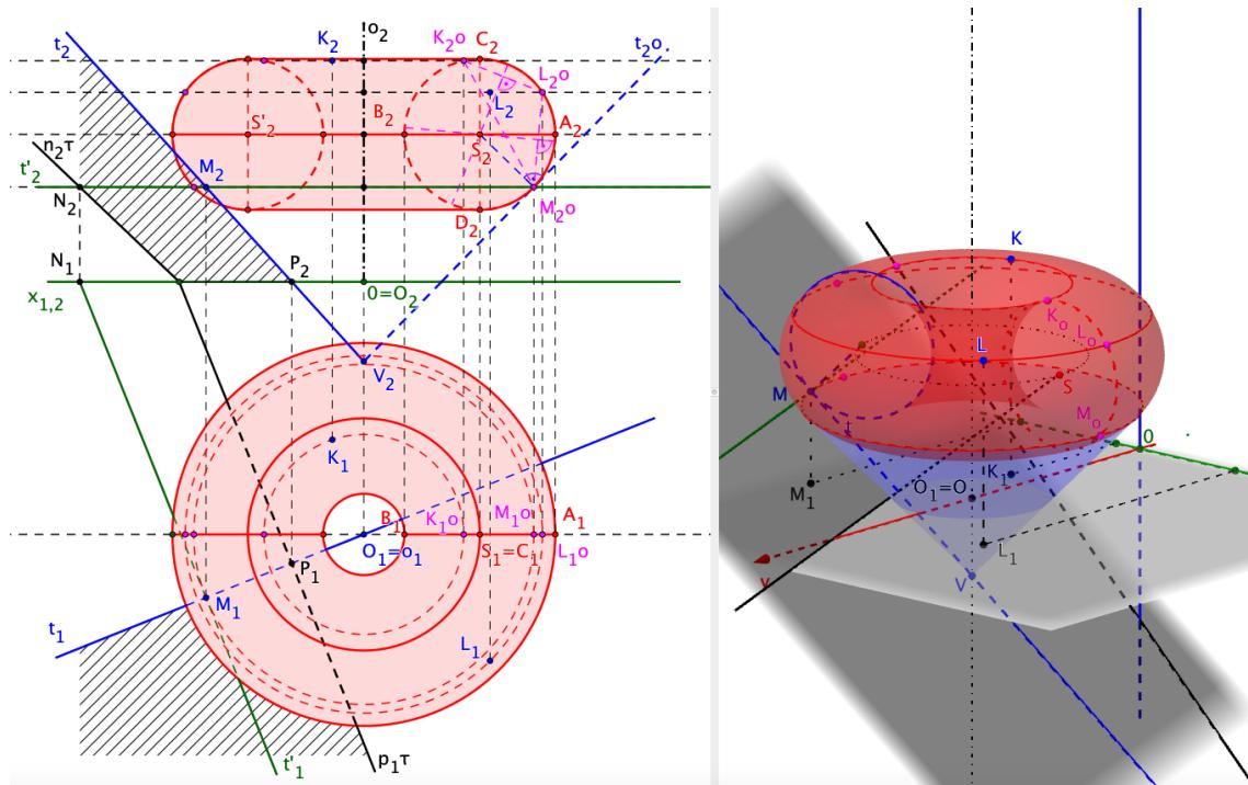
Ani jeden ze zadaných bodů neleží v rovině skutečného obrysu pro nárysnu (rovina rovnoběžná s nárysou procházející osou  $o$ ), takže je kolem osy  $o$  do této roviny otočíme. Otočené body určí tvořící kružnice pomocí níž odvodíme průměty plochy. V otočeném bodě  $M_o$  sestrojíme pomocnou tečnu obrysového poledníku (kružnice), která nám určí vrchol  $V$  tečné kuželové plochy, kterým prochází i tečna poledníku bodu  $M$ , doplníme tečnu rovnoběžky bodu a tak určíme tečnou rovinu.
