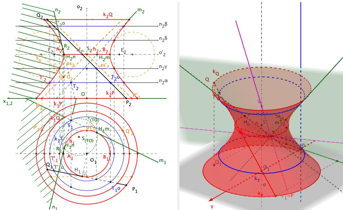
Úsečku  $PQ$  necháme rotovat kolem osy  $o$ , koncové body vytvoří kružnice podstav, bod  $H$  úsečky, který je nejblíž osy rotace, hrdelní kružnice. Odvodíme dostatečný počet bodů obrysové hyperbolky v nárysni, její asymptoty, oskulační kružnice a hyperbolu vykreslíme. Tečnou rovinu určíme dvojicí tvorících přímek procházejících bodem dotyku, případně dvojicí tečen plochy v daném bodě.
