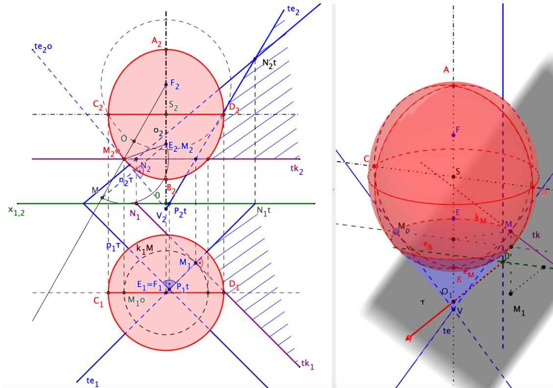
Bod  $M$  není bodem obrysové kružnice pro půdorysnu ani obrysové elipsy pro nárysnu, musíme ho otočil kolem osy  $o = EF$  do roviny obrysové elipsy pro nárysnu, která je rovnoběžná s nárysou s prochází osou  $o$ . Najdeme hlavní a vedlejší vrcholy obrysové elipsy a odvodíme půdorysný průmět. V otočeném bodě  $M_o$  sestrojíme pomocnou tečnu obrysové elipsy, která nám určí vrchol  $V$  tečné kuželové plochy, kterým
