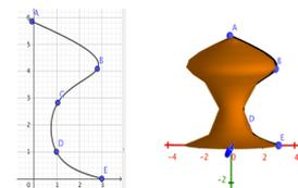
Mediante esta técnica (Spline) es fácil reproducir objetos con forma de superficies de revolución .
