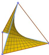
La superficie reglada construida sobre diagonales de caras opuestas de un cubo o un tetraedro es un paraboloid hiperbólico.
