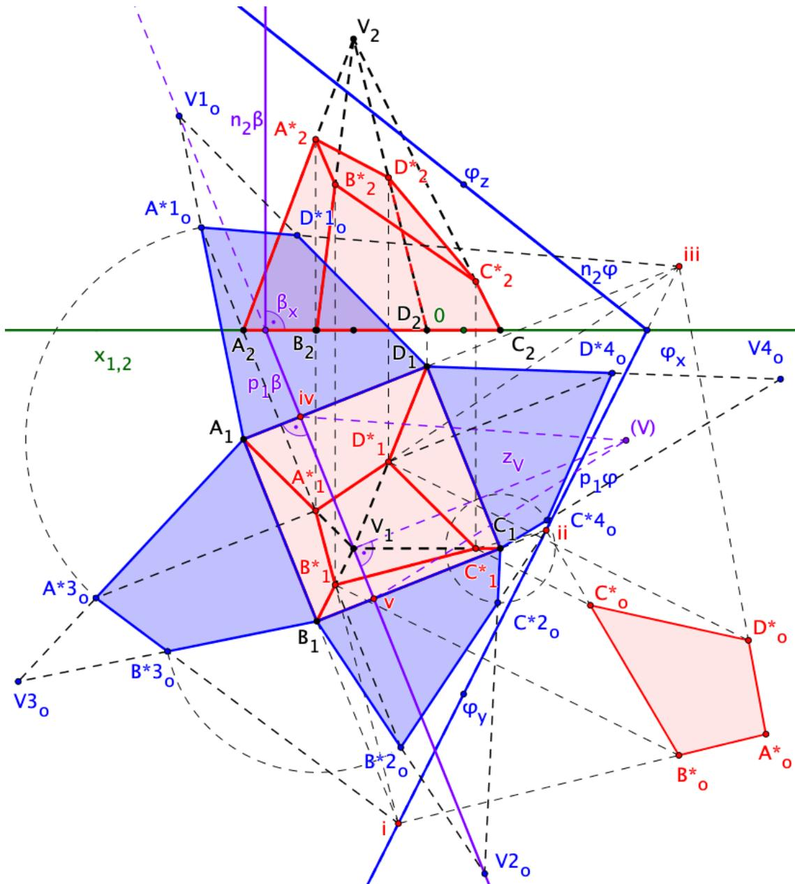
Otočíme roviny bočních stěn do půdorysny, protože těleso na půdorysně stojí, budou osami otáčení přímo hrany podstavy.
