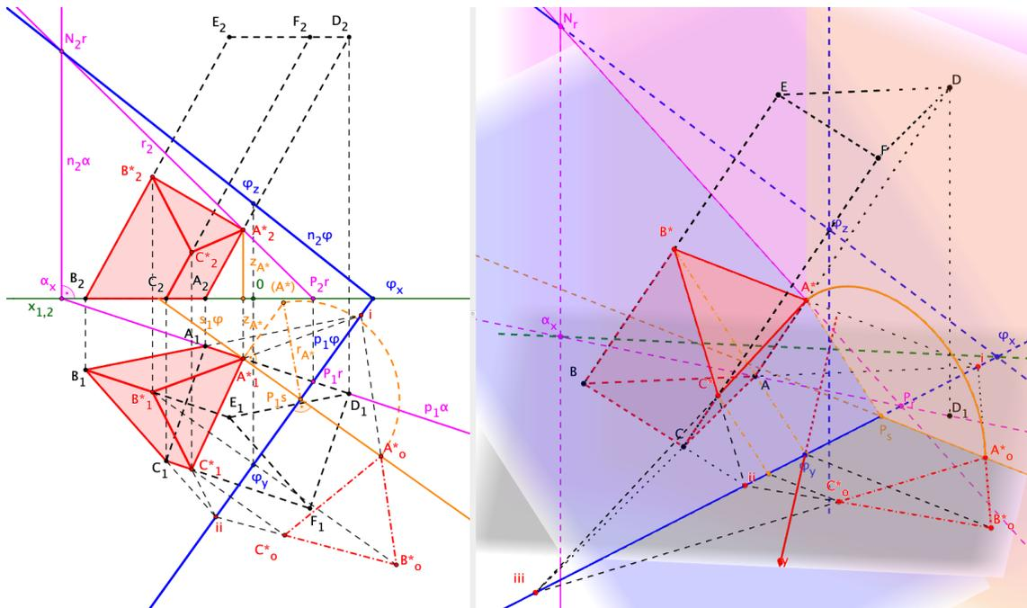
Na jedné z bočních hran tělesa najdeme první bod řezu. Touto hranou proložíme pomocnou rovinu např. kolmou k půdorysně, průsečnice pomocné roviny a roviny řezu určí průsečík. Body řezu na dalších hranách najdeme pomocí afinity. Otočením roviny řezu a rovin stěn do půdorysny můžeme sestrojít síť seříznuté části tělesa.
