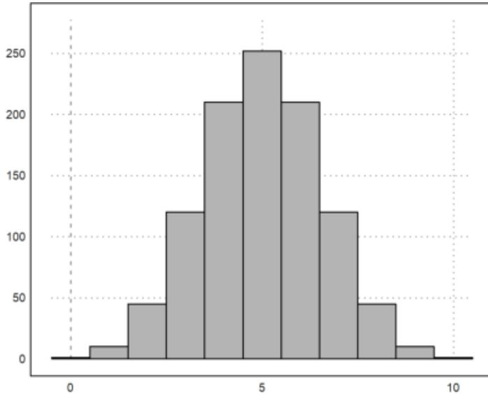
Data untuk plot batang (`bar=1`) dan histogram (`histogram=1`) dapat dinyatakan secara eksplisit dalam `xv` dan `yv`, atau dapat dihitung dari distribusi empiris dalam `xv` dengan `>distribusi` (atau `distribusi=n`). Histogram nilai `xv` akan dihitung secara otomatis dengan `>histogram`. Jika `>genap` ditentukan, nilai `xv` akan dihitung dalam interval bilangan bulat.
