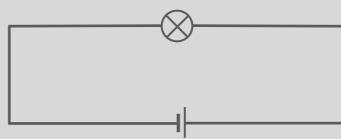
Ein Stromkreis besteht mindestens aus einer Stromquelle (Batterie), Leitungen und einem Verbraucher (Lämpchen).
