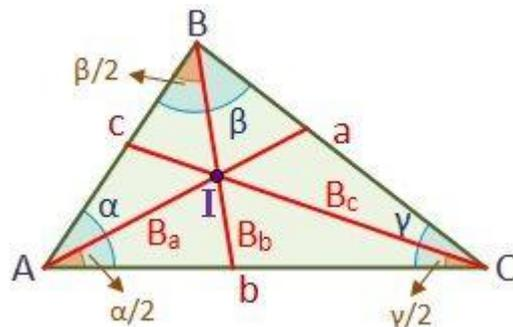
La bisectriz de un triángulo es el segmento que, dividiendo uno de sus tres ángulos en dos partes iguales, termina en el correspondiente lado opuesto.
