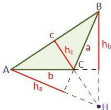
Las tres alturas del triángulo (o sus prolongaciones) se cortan en un punto llamado ortocentro ( $H$ ).
