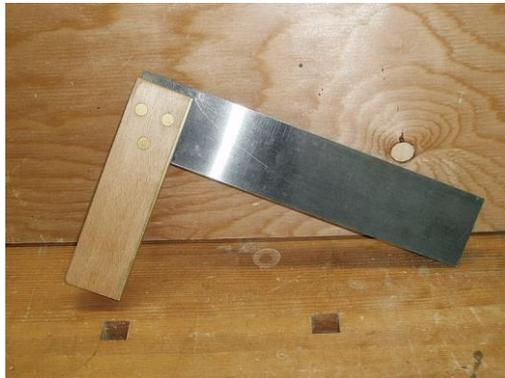
Einer die beiden Schenkel ist als Anschlag gestaltet, sodass er an geraden Kanten angelegt werden kann. In der Holzbearbeitung bestehen diese Anschlagwinkel aus Holz – oftmals aber in Kombination Stahl. Der dickere Schenkel wird dabei an der Materialkante angelegt.
