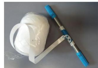
Man lässt das Band (wie in den folgenden Bildern sichtbar) mit dem Gewicht in den Rohstoffsilos, bis dieses auf dem Füllmaterial aufliegt.
