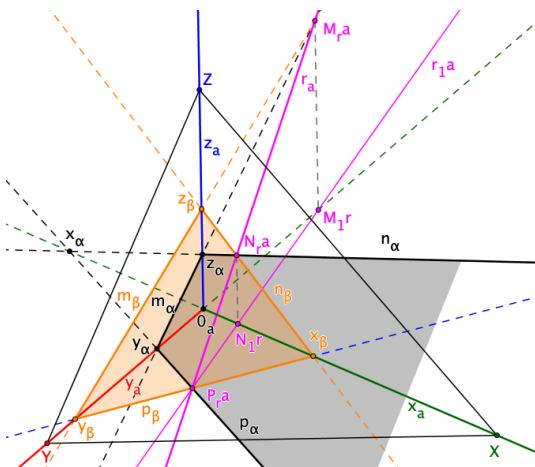
hledáme průsečíky příslušných stop, existují 3 průsečíky/stopníky, k určení průsečnice nám stačí ale libovolné dva
