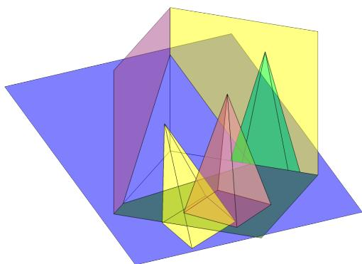
axonometrie - kolmé promítání na tři vzájemně kolmé pomocné průmětny a čtvrtou k nim kosou axonometrickou průmětnu
