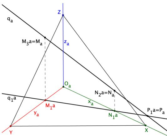
přímka je jednoznačně určena svým axonometrickým a např. prvním průmětem
