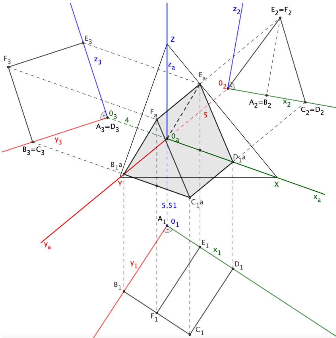
do vysunutých souřadných soustav vykreslíme příslušné průměty a jednotlivé body odvodíme pomocí paprsků rovnoběžných se směry vysunutí
