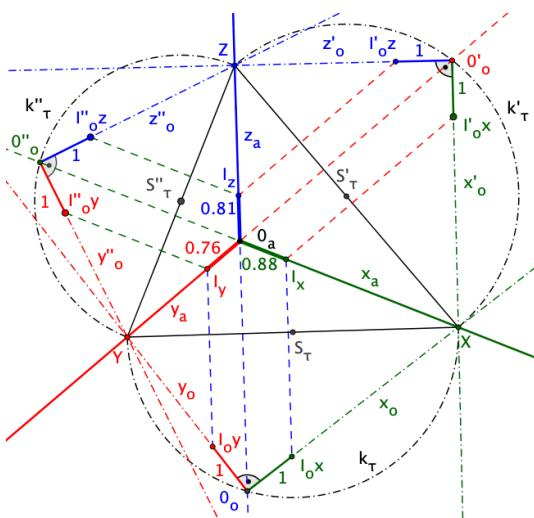
půdorysnu otáčíme do axonometrické průmětny kolem  $XY$ :
