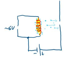
Zwischen der Glühwendel und einer Metallplatte mit Loch wird eine elektrische Spannung angelegt. Im entstehenden elektrischen Feld werden die Elektronen beschleunigt. Deshalb wird diese Spannung auch Beschleunigungsspannung genannt.
