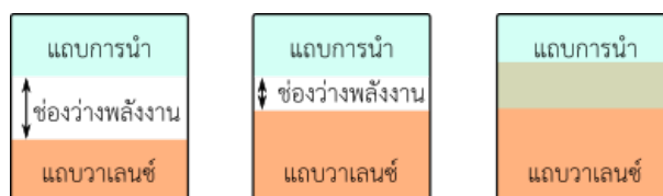
รูปที่ 10.2 ช่องว่างพลังงานของฉนวน สารกึ่งตัวนำและตัวนำไฟฟ้า
