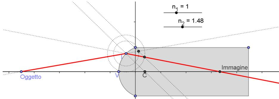
Misurando le distanze  $p$  e  $q$  dell'oggetto e dell'immagine dal vertice, possiamo sottoporre a verifica l'equazione dei punti coniugati che, in condizioni di raggi parassiali, è:
