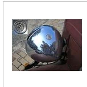
La parábola refleja sobre el foco los rayos paralelos al eje. Análogamente, un emisor situado en el foco, enviará un haz de rayos paralelos al eje.
