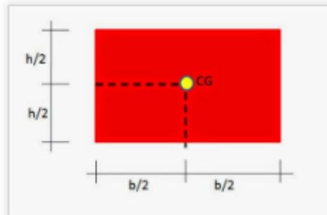
En nuestra figura, b corresponde a 4 m y h corresponde a 6 m, aplicando los datos en la forma que se nos indica la distancia del centroide al eje Y será:
