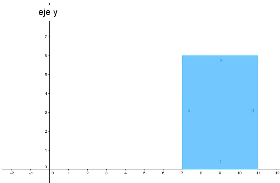
Para aplicar el teorema de Pappus-Guldin debemos identificar el área de la región, y la distancia del centroide de la figura al eje de rotación.
