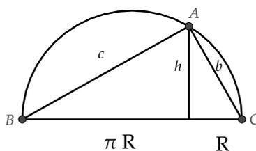
Como el segmento  $h$ , altura del triángulo, es media proporcional entre los segmentos que son proyecciones de los catetos sobre la hipotenusa (teorema de la altura), tendremos:
