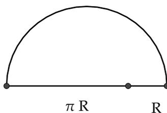
2. En el punto de unión de ambos segmentos levantamos una perpendicular, hasta que corte a la circunferencia
