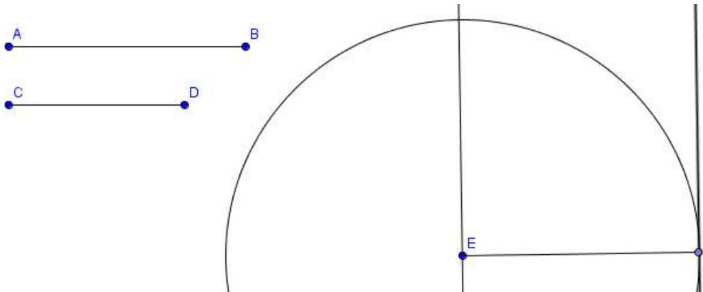
Utilizando de nuevo la herramienta **Compás**, llevamos la medida del segundo segmento a cualquiera de las perpendiculares que acabamos de trazar.
