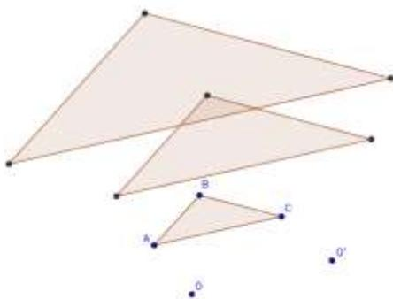
Para determinar el centro de la composición de las dos homotecias, trazamos dos rectas que unan puntos homotéticos del primer y del tercer triángulo; el punto de intersección O'' corresponde al centro de la homotecia composición.
