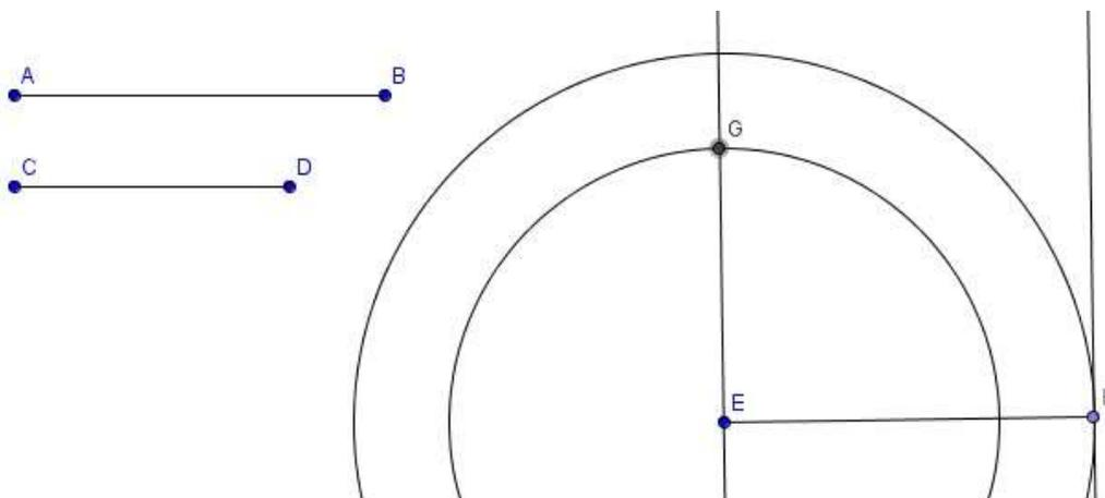
Para obtener cuarto vértice podemos repetir el proceso anterior, llevando de nuevo la medida del segmento, en este caso sobre el punto F; también podemos trazar la paralela al segmento EF por el punto G, para encontrar el punto de intersección que corresponde al cuarto vértice del rectángulo.
